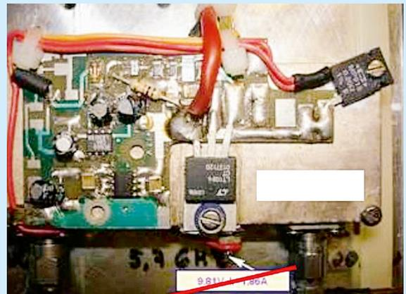
L'ampli sort maintenant 5,3 W saturés au lieu de 3,4 W → gain obtenu relativement minime !
