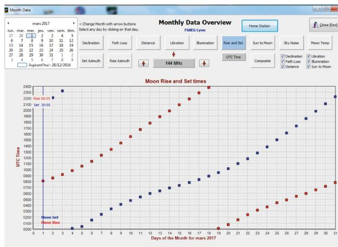
Enfin, pour déterminer la température de bruit du ciel, c'est l'onglet « Sky Noise ». Dans l'exemple ci-dessous, n'essayez pas entre le 18 et le 23 mars, la température du ciel monte jusqu'à 3 000°K, votre récepteur fera le bruit de la machine de Denis Papin. Pas top pour sortir des signaux du bruit.
