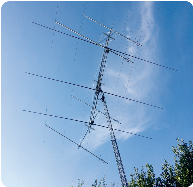
(Photo n°3) DL8YHR 4 x 5 éléments 50 MHz avec élévation et 3 éléments SteppIR
