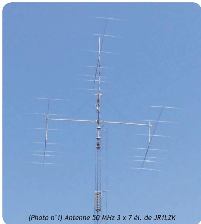
(Photo n°1) Antenne 50 MHz 3 x 7 él. de JR1LZK
