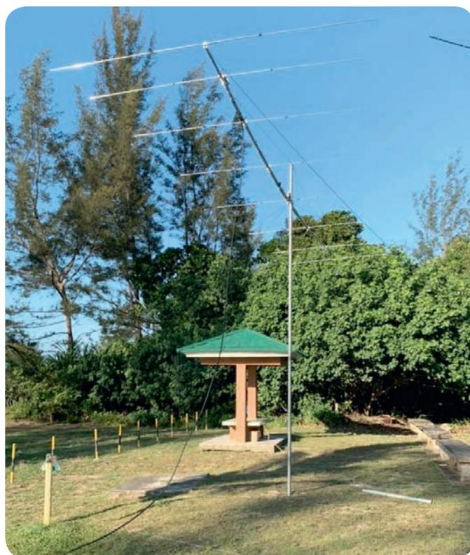
Antenne 50 MHz utilisée par V84SAA, uniquement 12 m de câble coaxial.
