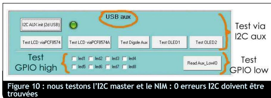
Figure 10 : nous testons l'I2C master et le NIM : 0 erreurs I2C doivent être trouvées
