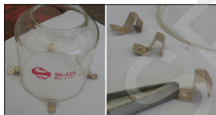
Photo 3 : Clips de fixation de la cheminée de ventilation
