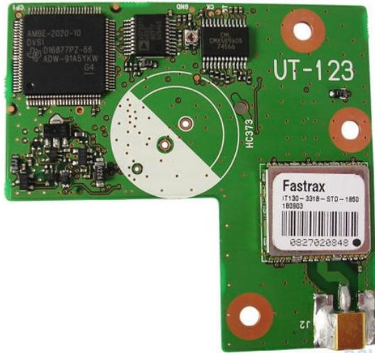
La différence entre un poste NBFM et D-STAR c'est un module à ajouter (cas du IC-E2820) ou inclus d'origine (ID-31, ID-51, ID-5100...)
