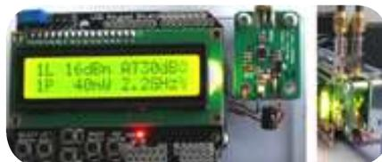
Fig. 2 : Arduino Uno connecté à deux modules AD8318
