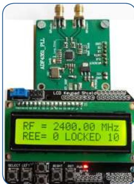
Fig. 10 : Générateur d'essai, module ADF4351 commandé par un Arduino Uno
