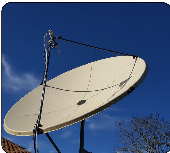
C'est ici une parabole prime-focus de 180 cm.
