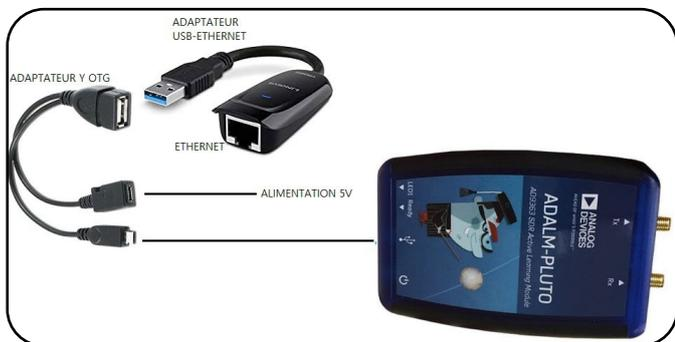
Nous avons besoin de raccorder le transceiver PLUTO en IP sur Ethernet via un adaptateur. J'ai utilisé un Linksys USB3GIG et un câble Y USB-OTG permettant l'alimentation externe du PLUTO.
