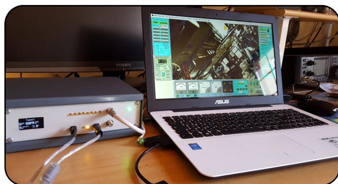
Voici la carte en semi-kit et ma réalisation en boîtier. Le récepteur est directement relié au PC affecté à cette fonction par une connexion USB et au LNB pour la réception 10 GHz. En fait, la réception se fait sur la fréquence intermédiaire puisque le LNB assure un changement de fréquence avec son oscillateur local sur 9750 MHz.
